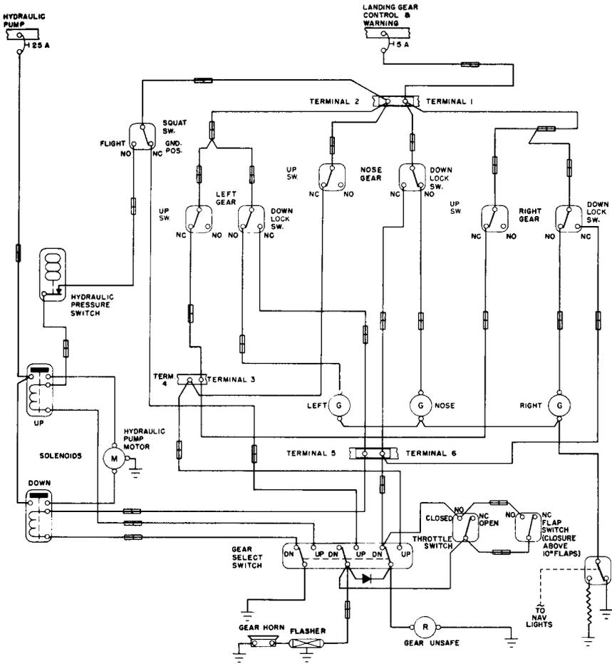
LANDING GEAR ELECTRICAL SYSTEM SCHEMATIC
